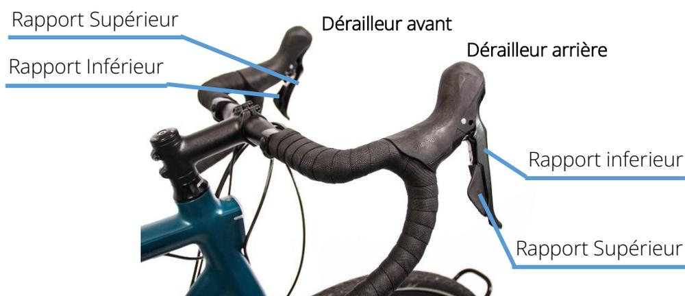
Spécificité transmission à chaîne : Votre dérailleur avant possède quatre crans de réglage :
