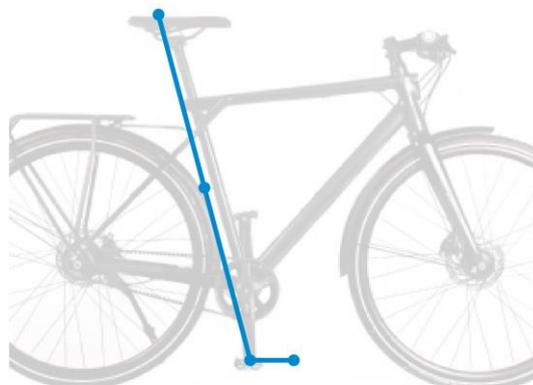
*A noter, il vous est également possible de régler l'inclinaison ainsi que le recul de votre selle sur le plan horizontal à l'aide des deux vis situées sous la selle.*
