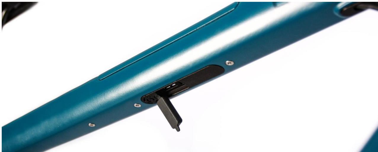
Le port de recharge Micro-USB du vélo se trouve sous le tube supérieur. Un port USB permet également de recharger un appareil externe en 5 VDC et 500 mA (équivalent aux ports USB de votre PC). Attention, cette fonctionnalité aura pour effet de décharger plus ou moins rapidement le vélo.
