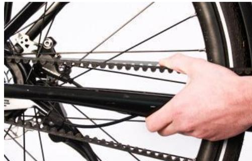
Si la tension de courroie est inappropriée, desserrez légèrement les deux vis du boîtier de pédalier excentrique avec la clé Allen 4mm. À l'aide du tendeur de courroie, réglez l'excentricité du pédalier pour ajuster la tension de la courroie et revissez fermement les deux vis du boîtier de pédalier (6 Nm) à l'aide de la clé Allen 4mm.
