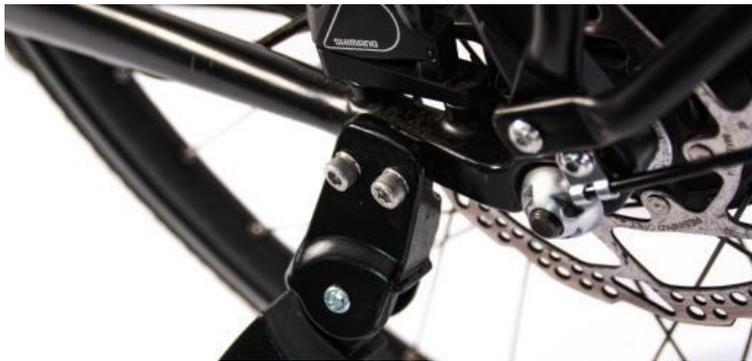
**Béquille centrale** : Vissez la béquille à l'aide d'une clé Allen 8mm à l'emplacement prévu. La rondelle doit être placée vers le haut (côté opposé à la béquille). Faire très attention de ne pas pincer les câbles électriques lors de l'installation de la béquille.
