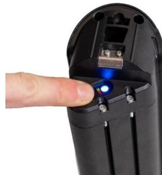
Pour recharger la batterie, retirer l'élément en caoutchouc situé sur le bord supérieur gauche afin d'y brancher le chargeur fourni avec le vélo. La batterie peut rester sur le vélo ou être retirée pendant la phase de chargement.
