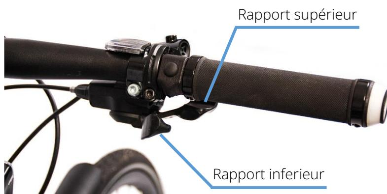
Les changements de vitesses doivent se faire en pédalant modérément. Il faut éviter tout passage en force des vitesses. Il est conseillé de se familiariser avec votre système de vitesse dans un environnement à l'écart de la circulation. Une mauvaise utilisation du système de vitesse (exemple : rester en permanence sur un seul rapport, rapport mal ajusté en fonction de la pente...) peut être la cause d'une usure prématurée de certains composants (chaîne, cassette, moteur électrique...)
