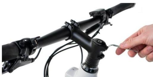
Vérifiez l'absence de jeu vertical dans la direction. Au besoin, desserrez les deux vis à l'arrière de la potence puis resserrez légèrement la vis sur l'axe de direction à l'aide de la clé Allen 5mm. Si la rotation de la direction devient plus rigide, desserrez légèrement la vis.
