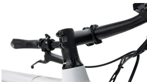
Orientez le cintre de manière à incliner les leviers de frein d'environ 35° et revissez fermement les quatre vis (6 Nm). Veillez à positionner le guidon de sorte qu'il soit centré grâce au repère
