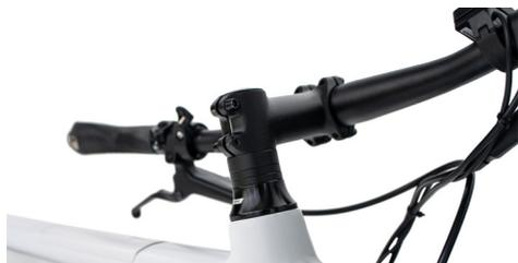
Orientez le cintre de manière à incliner les leviers de frein d'environ 35° et revissez fermement les quatre vis (6 Nm). Veillez à positionner le guidon de sorte qu'il soit centré grâce au repère.
