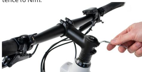
Vérifiez l'absence de jeu vertical dans la direction. Au besoin, desserrez les deux vis à l'arrière de la potence puis resserrez légèrement la vis sur l'axe de direction à l'aide de la clé Allen 5mm. Si la rotation de la direction devient plus rigide, desserrez légèrement la vis.
