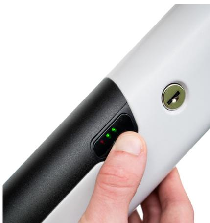
Pour recharger la batterie, retirer l'élément en caoutchouc situé sur le bord supérieur gauche afin d'y brancher le chargeur fourni avec le vélo. La batterie peut rester sur le vélo ou être retirée pendant la phase de chargement.
